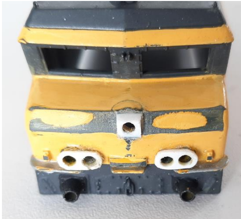
Topsein geplaatst en op maat gevijld...
